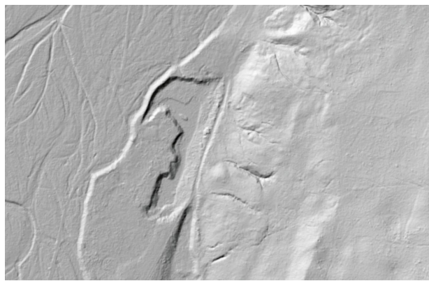
Bild 4: Konturen der früheren Kiesgrube im Digitalen Geländemodell
