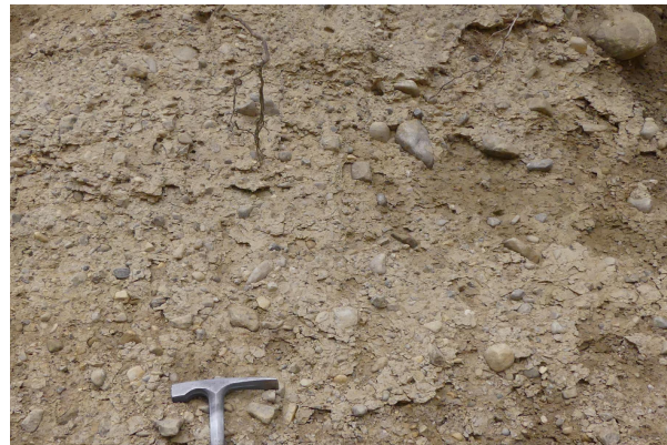
Bild 2: Schluffige Grundmoräne mit kleinen Geschieben
