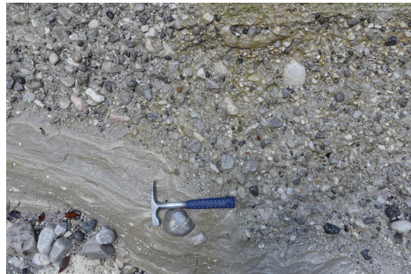
Bild 2: Schotter über Feinsand mit Geröllen und über Beckenschluff
