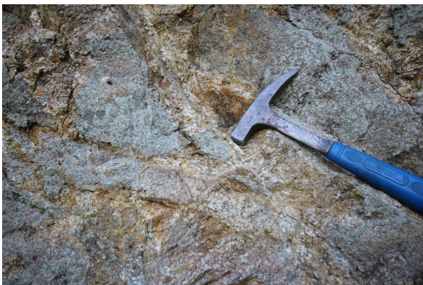
Bild 3: Detailansicht des verwitterten Biotit-Granits.
