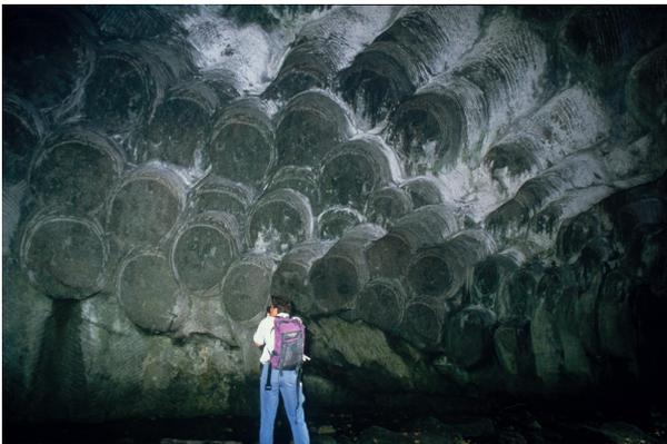
Bild 1: Abbauspuren zur Mühlsteingewinnung im Fels
