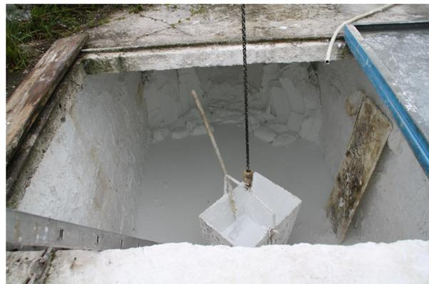
Bild 4: Löschkalkgrube
