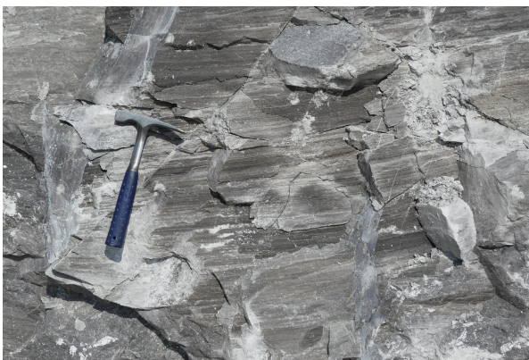
Bild 3: Gips, unrein, massig, feingeschichtet
