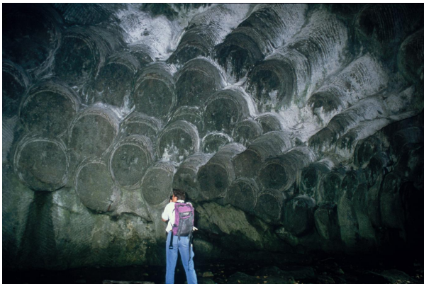
Bild 1: Abbauspuren zur Mühlsteingewinnung im Fels
