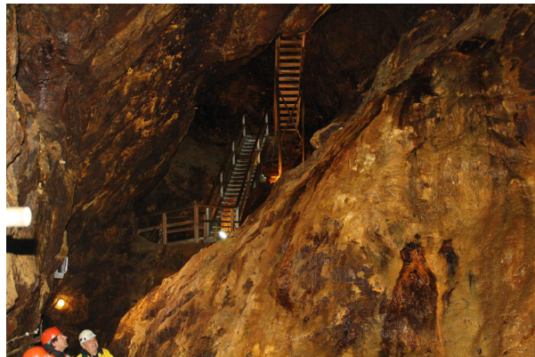
Bild 2: Im Bergwerk wurden zahlreiche Holztreppen eingebaut, um auf die verschiedenen Sohlen zu gelangen.
