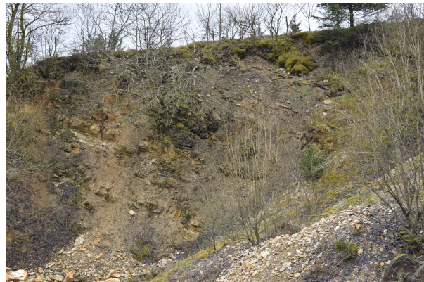
Bild 2: Ehemaliger Abbaustoß mit flachem Schichteinfallen
