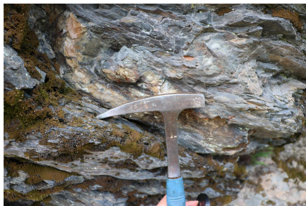
Bild 4: Die Falten innerhalb der Schieferabfolgen sind teilweise schwer von der eigentlichen Schieferung oder Versatzzonen zu unterscheiden.
