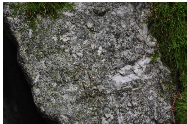
Bild 4: Granit mit großen Feldspat-Einsprenglingen.
