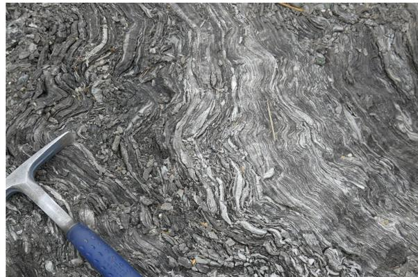
Bild 2: Gips-Tonstein-Wechsellagerung, verfältelt
