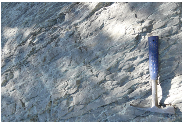
Bild 3: Detailansicht des leicht grünlich gefärbten Sandstein mit Glaukonit
