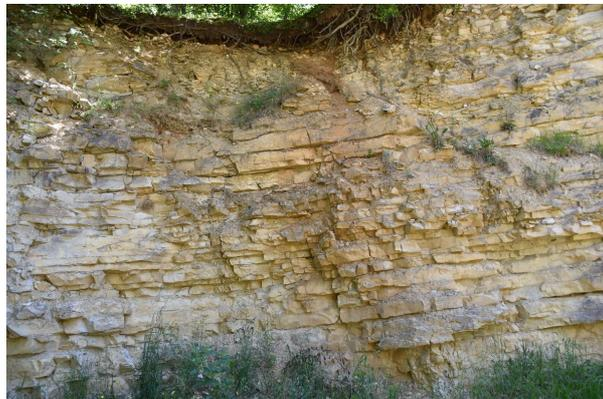
Bild 2: Abbaustoß mit gebanktem Kalkstein
