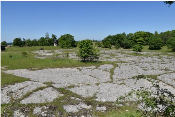
Bild 1: Bruchsohle mit auffälliger Klüftung
